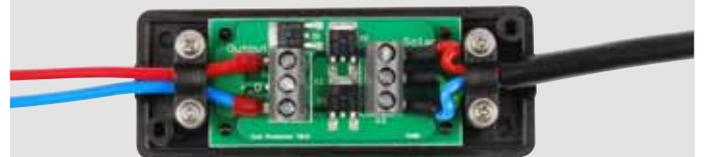
Mit dieser Anschlussart werden die Zellen durch zwei Bypass-Dioden vor dem Hotspot Effekt geschützt.
